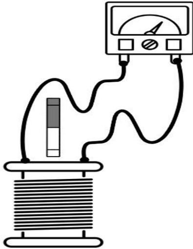
La aplicación más común de la inducción electromagnética es la generación de electricidad, cuando una bobina de material conductor, generalmente de cobre, se mueve en presencia de un campo magnético producido por ejemplo por un imán. Las líneas del campo magnético del imán hacen que fluyan los electrones en el cable de la bobina. Este hecho fue descubierto por el científico Michael Faraday, quien comprobó que se puede generar una corriente eléctrica cuando se modifica un campo magnético.
